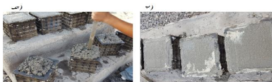
شکل ۲- (a) نمونه گیری بتن ؛ (b) نمونه ها مکعبی در پایان نمونه گیری
