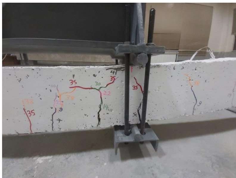
شکل ۱۲ تیر بتن مسلح تقویت شده با میلگرد GFRP بعد از بارگذاری
