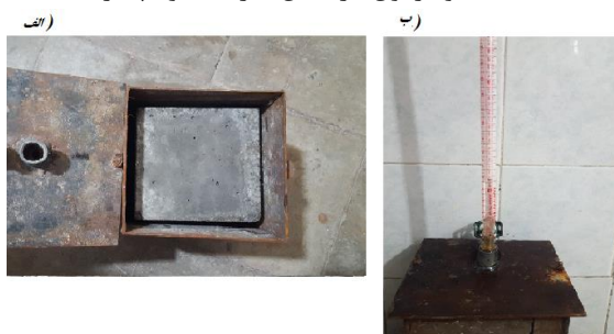
شکل ۳- (الف) نمای داخل دستگاه تست نفوذپذیری (ب) نمونه در حال آزمایش
