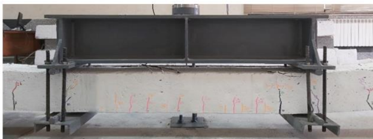
شکل ۸. مقایسه تیر بتن مسلح تقویت شده با ورق CFRP بعد از بارگذاری - RB1
