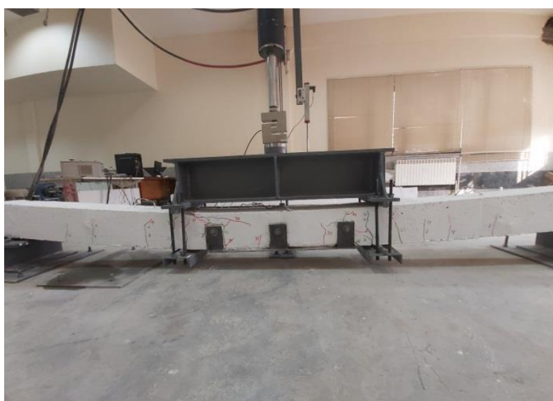
شکل ۱۵- نحوه بارگذاری تیر بتن مسلح تقویت شده با ورق فولادی
