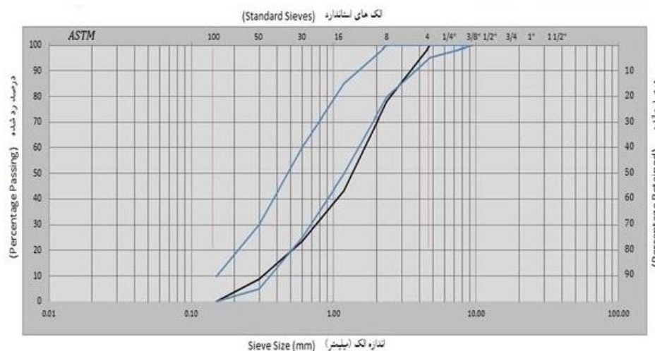
شکل ۶: منحنی دانه‌بندی سنگدانه ریز بتن بازیافتی استفاده شده در این تحقیق
