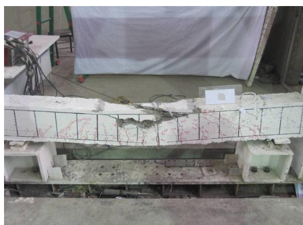
شکل ۱۱- وضعیت نهایی تیر آزمایشگاهی HP35.7-60 و آسیب های فشاری و کششی تیر FHP35.7-60
