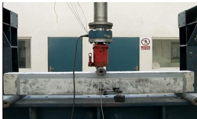
شکل ۴ نحوه آزمایش بار سه نقطه‌ای فزاینده
