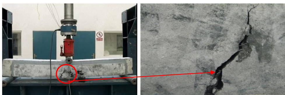
شکل ۶ نحوه ترک خوردگی تیر تقویت شده از نوع S-re
