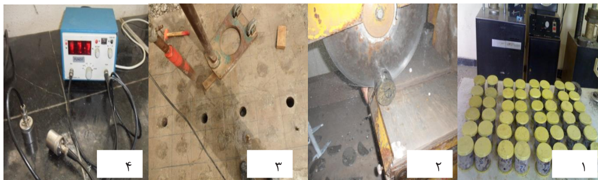
شکل ۶- الف) دستگاه پاندیت ب) دستگاه مغزه گیری ج) برش نمونه های مغزه گیری شده د) کلاhek گذاری نمونه های مغزه گیری شده
