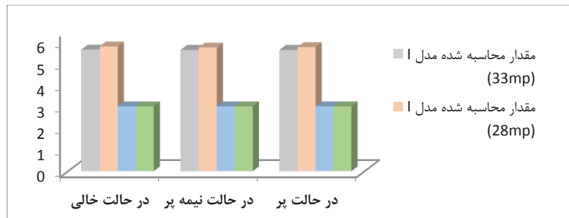
شکل ۱۶: نمودار ضریب رفتار محاسبه شده و آیین‌نامه‌ها در مدل II با مقاومت بتن ۲۸ و ۳۳ مگاپاسکال
