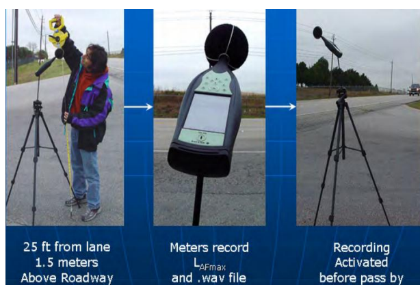
روش های نصب میکروفون در کنار جاده ۲۸ (CPB) و ۲۹ (SPB)
