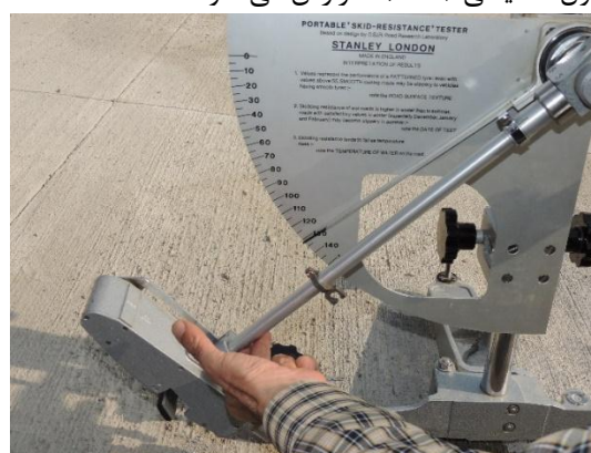
شکل ۱۰ - روش پاندول انگلیسی ۳۱ (BPT)
