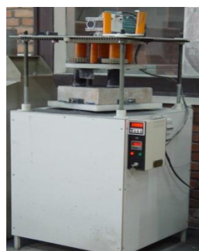
شکل ۳- دستگاه آزمایش ASTM C779 (دیسک چرخان) و نحوه قرائت عمق سایش بعد از انجام آزمون مطابق ASTM C779
