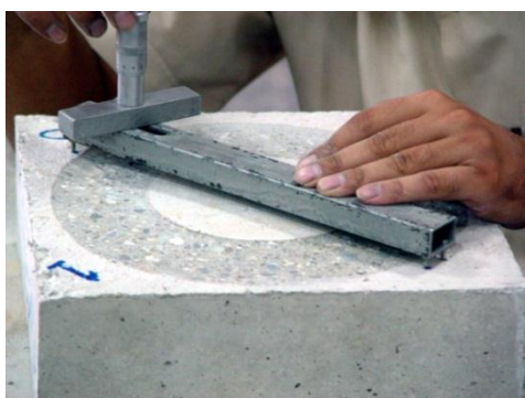
شکل ۳- دستگاه آزمایش ASTM C779 (دیسک چرخان) و نحوه قرائت عمق سایش بعد از انجام آزمون مطابق ASTM C779
