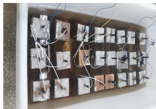
شکل ۱: نمونه‌های بتنی تحت آزمایش خوردگی تسریع شده
