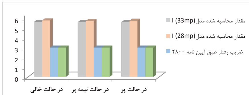
شکل ۱۵: نمودار ضریب رفتار محاسبه شده و آیین نامه ها در مدل I با مقاومت بتن ۲۸ و ۳۳ مگا پاسکال
