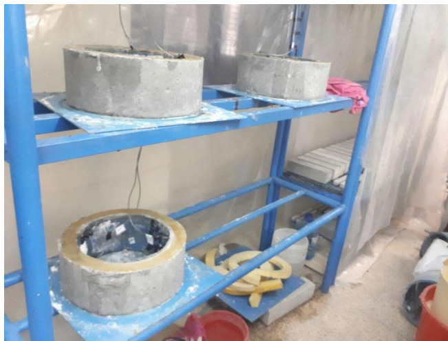
شکل ۴- آزمایش جمع شدگی ناشی از خشک شدن بتن مقید.
