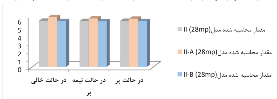
شکل ۱۷: نمودار ضریب رفتار محاسبه شده ۳ مدل II-A، II-B و II با مقاومت ۲۸ مگاپاسکال
